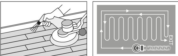
Reinigungs-/Pflegemittel gemäß Herstellervorschrift verdünnen. Einscheibentellermaschine mit rotem oder weißem 3M-Pad verwenden. Feinen Sprühfilm aufbringen, Maschine mit überlappenden Bewegungen abfahren bis der Boden sauber ist. Diese Methode eignet sich besonders für die Entfernung von hartnäckigen Flecken und Begehspuren.
